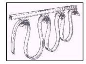
Los sistemas de electrificación del puente tipo festoon pueden incluir un cable de suspensión de acero inoxidable y cables plásticos inoxidables para el trole.
